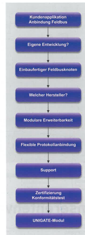
Abb.: Einzelne Schritte zur Anbindung einer Applikation an einen Feldbus.
