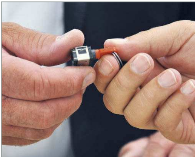
Über einen Schüsselschalter am Gerät lassen sich Zugriffsrechte regeln.
