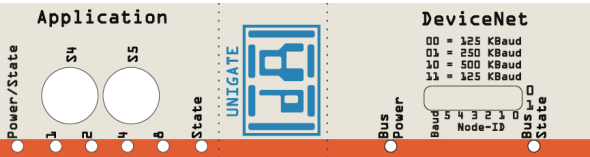
Bild 2: Frontblende: Drehschalter, DIP-Switch und Leuchtanzeigen
