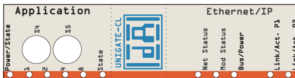
Bild 2: Frontblende: Drehschalter und Leuchtdioden
