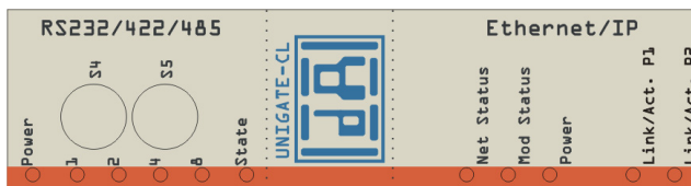
Bild 2: Frontblende: Drehschalter und Leuchtanzeigen
