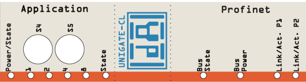
Bild 2: Frontblende: Drehschalter und Leuchtanzeigen
